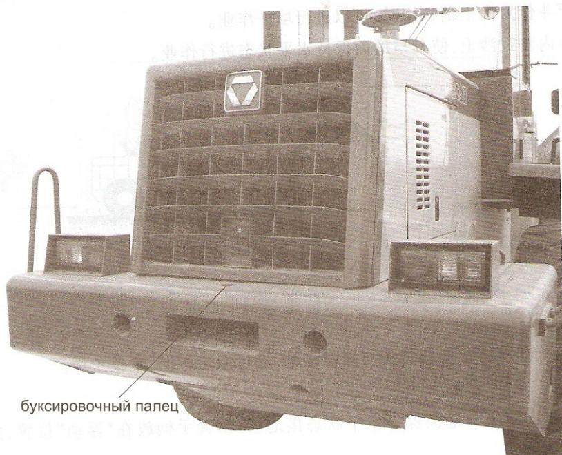
Рис. 1-82 Фотография буксировочного пальца
