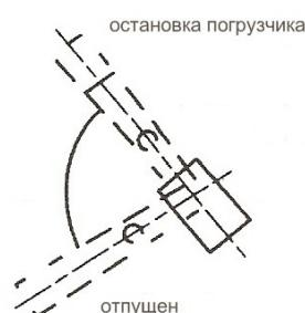
Рис. 16 Положение рычага управления
