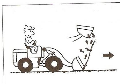
Рычаг управления движущимся рычагом находится в положении подъема, управляйте цилиндром ковша, на низкой скорости переверните ковш 2-3 раза до полного заполнения ковша.
