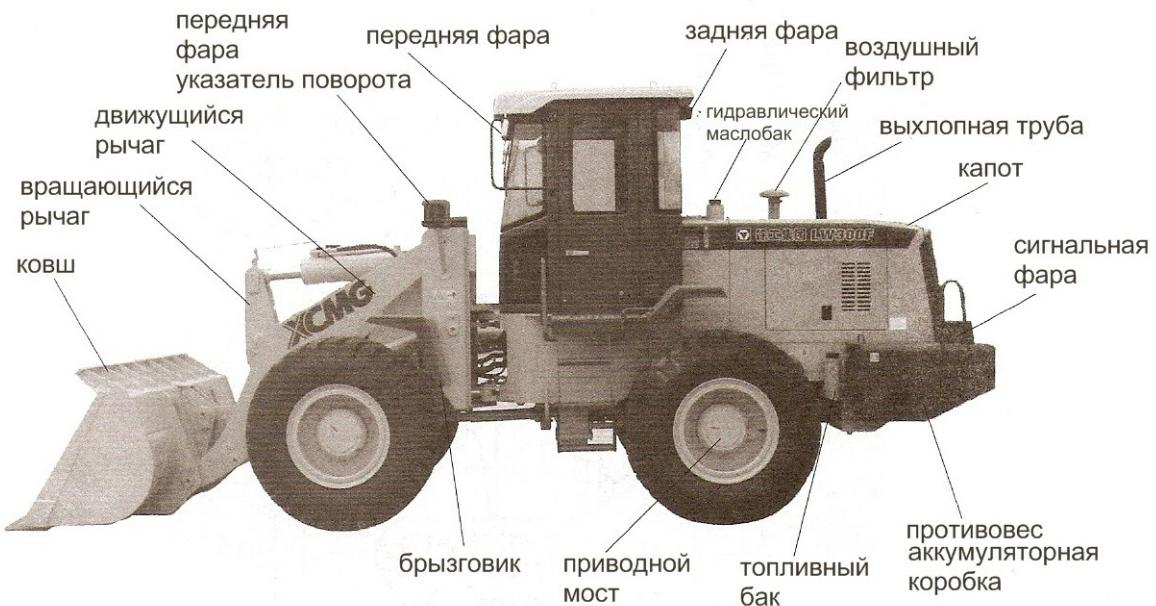
Рис.1-1 Внешний вид погрузчика и наименование деталей
