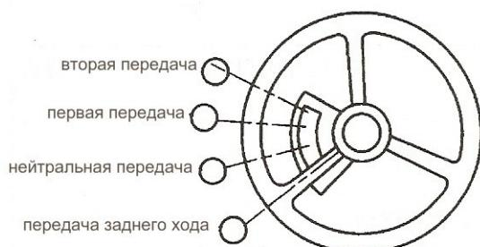
Рис. 1-12 Положения рычага переключения
