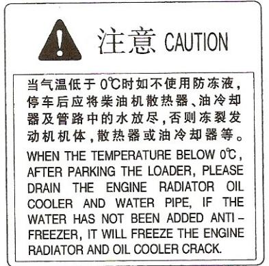
Если при температуре воздуха ниже 0°C не используется антифриз, то после остановки погрузчика необходимо слить воду из радиатора, масляного охладителя, трубопровода. В противном случае это приведет к появлению трещин на корпусе двигателя, радиаторе или охладителе.
