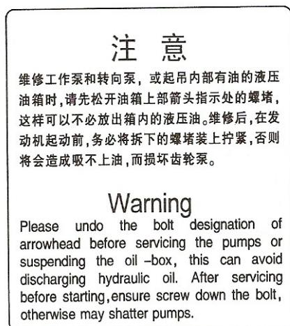
Если при ремонте рабочего насоса, рулевого насоса в гидравлическом маслобаке есть гидравлическое масло, открутите пробку бака. Это позволит не спускать мало из бака. После ремонта перед запуском двигателя закрутите пробку, в противном случае масло не поступит в маслопровод и это приведет к поломке шестеренчатого насоса.
